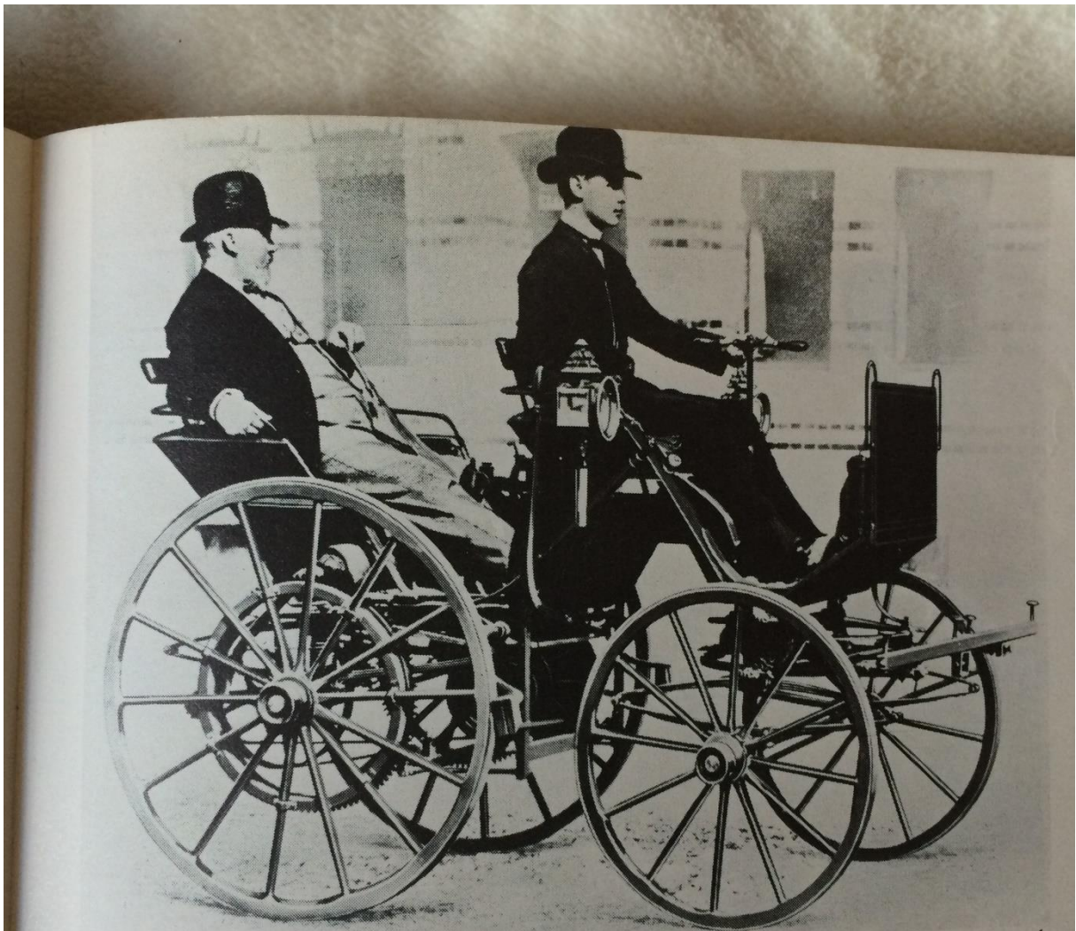
Am 4. März 1886 legt Gottlieb Daimlers Motorkutsche die Strecke von Cannstatt nach Stuttgart mit den berühmten 18 km/h zurück. Daimler verzichtete zunächst auf eine eigene Konstruktion eines Wagens und baute seinen Motor in eine der üblichen Kutschen ein, weil er der Meinung war, daß der neue Motor lediglich die Pferde jeder beliebigen Kutsche
